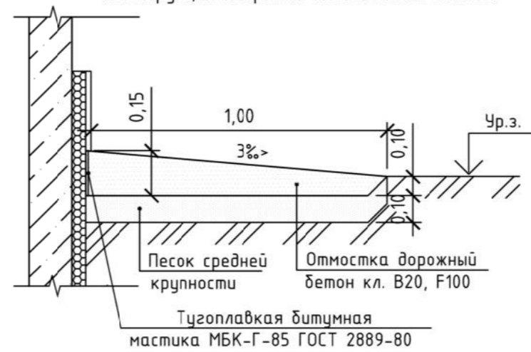
Конструкция покрытия откоски из бетона
